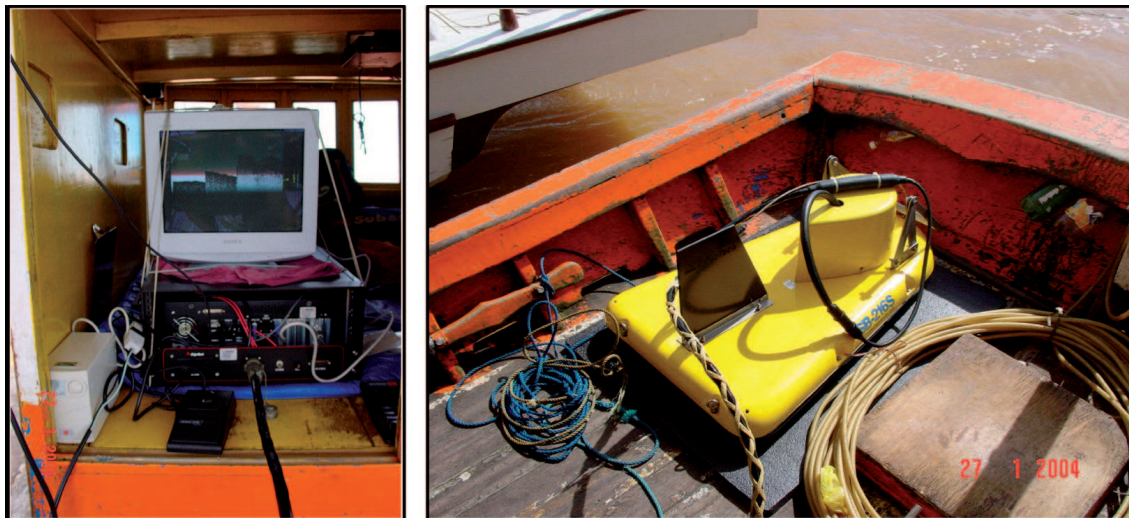
Figura 4: Sistema de geofísica rasa Geostar (à esquerda) e fonte de emissão/recepção do sinal Acústico do tipo “Tow-Fish”, CHIRP, multi-frequências (2-16 kHz).
